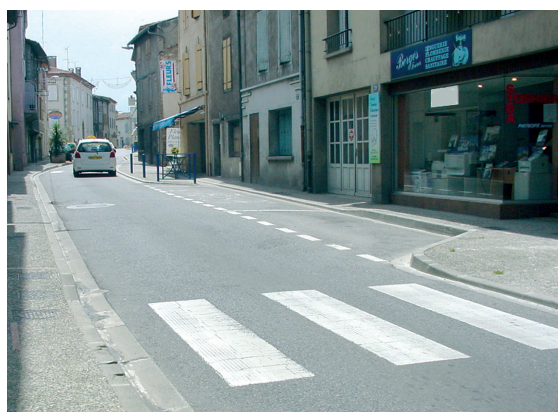
Une avancée de trottoir a été créée, elle permet de gérer la distance entre le stationnement et le passage piéton, améliorant les visibilités réciproques des usagers. La distance à parcourir sur la chaussée lors de la traversée piétonne est, de plus, réduite.
