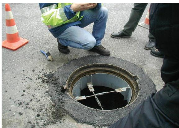
**Test du produit de scellement sur le terrain en présence de M. Moto et des associations de motards**
