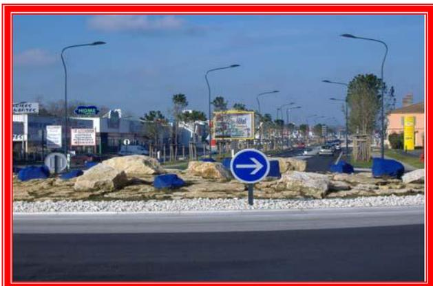
Les rochers placés au milieu du rond-point représentent un risque de lésions majeures voire mortelles en cas de glissade et / ou d'éjection d'un pilote de moto ou de cyclomoteur. Le rocher n'a en effet aucune souplesse d'absorption des chocs. C'est donc l'organisme du pilote qui se prend toutes les ondes de choc et les lésions qui en découlent.
