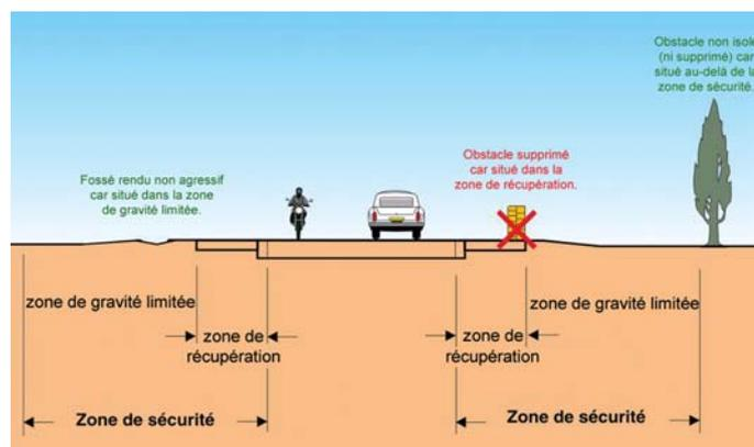
Ses fonctions sont la récupération des véhicules proprement dite (elle sert à aider un conducteur à reprendre la maîtrise de son véhicule après un écart), l'évitement des autres véhicules pour empêcher les collisions, l'arrêt d'urgence, la circulation des piétons. Elle facilite aussi les opérations d'entretien. Lorsque celle-ci est revêtue (on l'appelle aussi **accotement revêtu** ou **bande multifonctionnelle**), la circulation des cyclistes<sup>1</sup> qui le souhaitent y est autorisée.
