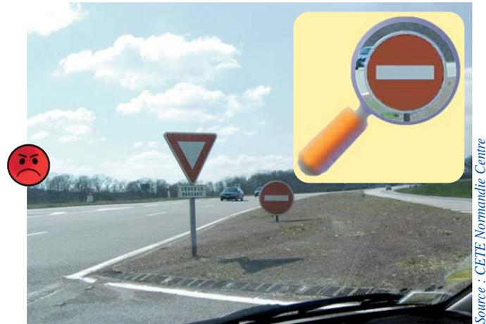
Pour limiter les risques de collision du véhicule qui tourne à gauche par un usager en dépassement, il est possible, quelque soit le milieu (urbain ou interurbain), et s'il s'agit de l'intersection de deux routes de même niveau de trafic et de calibration, de réaliser un giratoire ou un minigiratoire qui apportent une meilleure sécurité.
