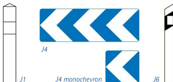
Pour que les usagers puissent adapter leur comportement au virage, il est important que la signalisation reflète la difficulté du virage. Une homogénéité dans l'implantation de la signalisation doit être recherchée sur l'ensemble du territoire.
